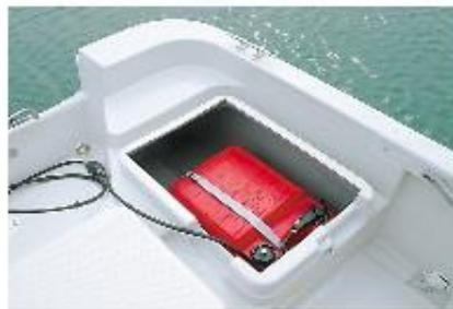
スターン燃料タンクスペース
