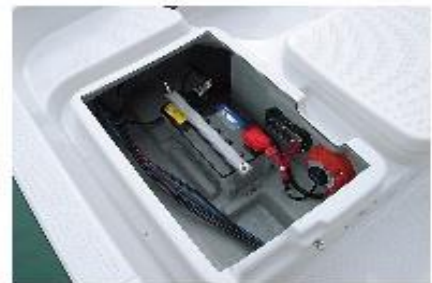
スターンバッテリースペース
