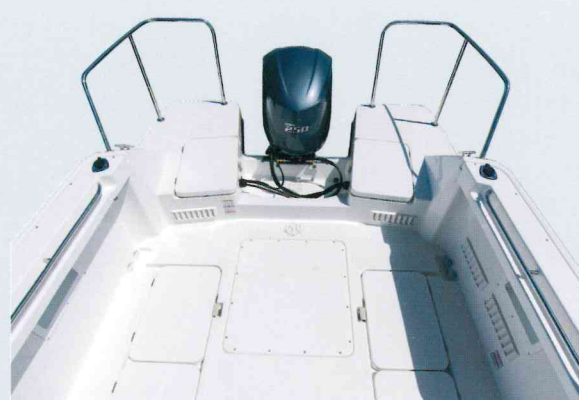
スターンデッキ ファイト時の動きを考慮したワイドでフラットなスペース。ガンネルには釣り機装などを考慮したオープンガンネルを採用。埋め込み式ロッドホルダー(用品OP)などの取り付けを容易にしています。
