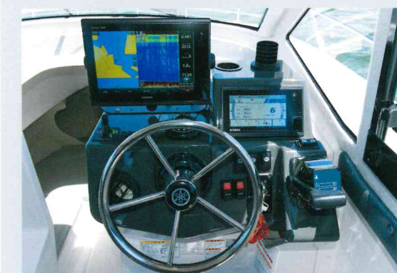
コックピット タッチスクリーンディスプレイ「CL7」を採用。フレッシュエアファン(OP)は外気を取り入れることができるため、空調効果が得られ、また、取り入れた外気をフロントウィンドウに当てた場合には、曇り止めの効果を発揮します※諸条件により、空調や曇り止め効果は変化します。
