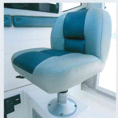
ドライバーズシート スライド&油圧ダンパー式ドライバーズシート。操船者に合ったドライビングポジションにセットすることができ、快適なロングクルージングをサポートします。
