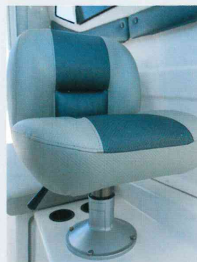
ナビシート ドライバーと同じ目線で、良好な前方の視界を確保するナビシート。EX仕様にはスライド&油圧ダンパー式を採用しています。
